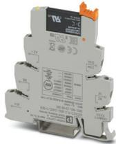
PLC-INTERFACE para funciones de entrada, compuesto de borne de base PLC-BSC.../SEN con conexión por tornillo y relé de estado sólido en miniatura enchufable, para el montaje sobre carril NS 35/7,5, 1 contacto de cierre, entrada: 24 V DC, salida: 3-48 V DC/100 mA
