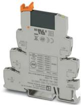
PLC-INTERFACE, compuesto de borne de base PLC-BSC.../21 con conexión por tornillo y relé de estado sólido en miniatura enchufable, para el montaje en carril NS 35/7,5, 1 contacto de cierre, entrada: 24 V DC, salida: 3-48 V DC/100 mA
