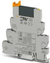
PLC-INTERFACE para funciones de salida, compuesto de borne de base PLC-BSC.../ACT con conexión por tornillo y relé de estado sólido en miniatura enchufable, para el montaje sobre carril NS 35/7,5, 1 contacto de cierre, entrada: 24 V DC, salida: 3-33 V DC/3 A
