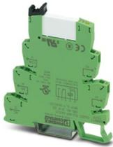
PLC-INTERFACE, compuesto de borne de base PLC-BSP.../21 con conexión por resorte y relé en miniatura enchufable con contacto de oro multicapa, para montar sobre carril NS 35/7,5, 1 contacto conmutado, tensión de entrada 24 V AC/DC
