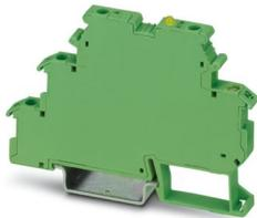
Relé de estado sólido de entrada, con contrafase de salida de tensión continua, frecuencia de transferencia de 100 kHz, con indicador luminoso y circuito de protección en circuito de entrada y salida, entrada: 24 V DC, salida: 14 - 30 V DC/50 mA
