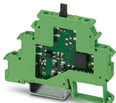
Terminal de relé de estado sólido de introducción, entrada: 24 V DC, salida: 3 - 48 V DC/100 mA, con clavija de interrupción en salida, ancho de borne 6,2 mm
