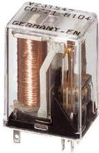
KAMMRELAIS®, contacto B 104, tamaño 1, contacto para corriente de baja intensidad, 2 contactos conmutados, tensión de entrada 120 V AC
