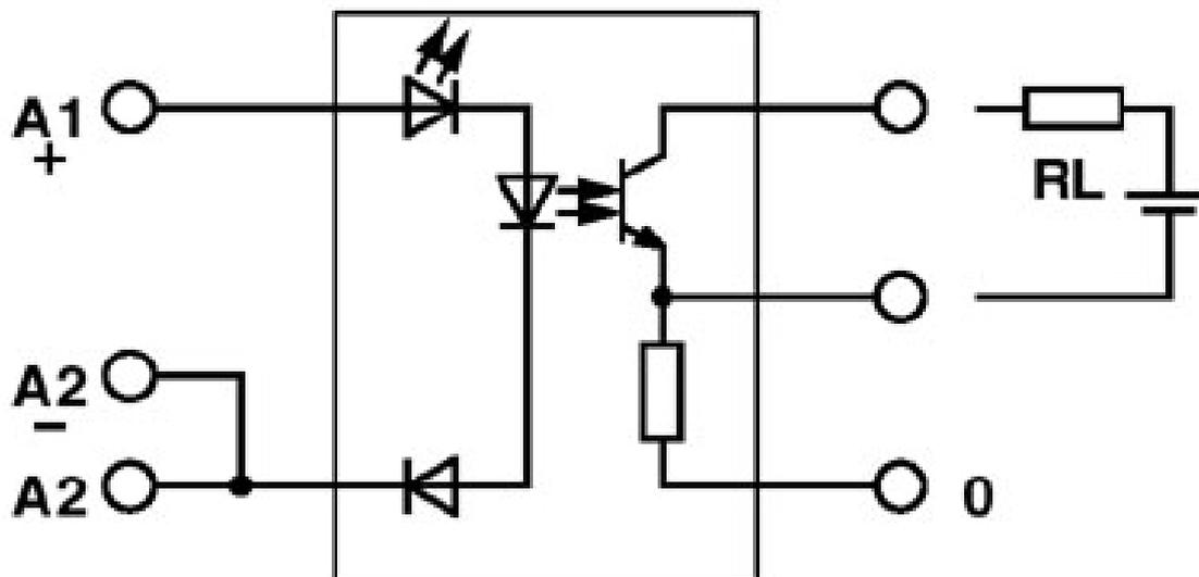
Salida: 2 conductores, sin masa, conexión a negativo
