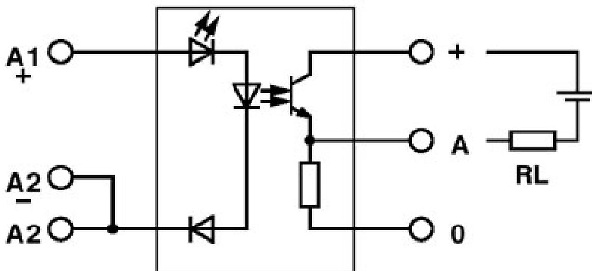
Salida: 2 conductores, sin masa, conexión a positivo
