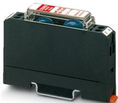
Módulo para montaje sobre carril con protección media contra sobretensiones, equipado con 2 varistores de conexión individual, montaje sobre NS 35/7,5 Tensión nominal: 24 V AC, anchura de la carcasa: 12,5 mm
