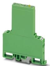
Relé de estado sólido de potencia, con indicador luminoso y circuito de protección en circuito de entrada y salida, entrada: 220 V DC, salida: 5-36 V DC/máx. 1 A
