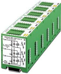
Módulo de relé, de varios canales, con 4 mini-relés de conmutación soldados para tensión continua, con indicación luminosa y 1 contacto conmutado respectivamente, contacto para potencias medianas hasta grandes, tensión de entrada 24 V DC
