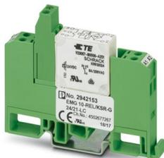
Módulo de relés, con mini-relé de conmutación soldado, contacto (AgNi): Potencias medianas hasta grandes, 1 contacto conmutado, tensión de entrada 24 V DC
