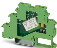
Borne-relé, con relés miniatura soldados, contacto (AgNi+Au): Potencias pequeñas hasta medianas, 1 contacto abierto, tensión de entrada 5 V AC/DC, para montaje sobre NS 35/7,5, anchura de borne 6,2 mm
