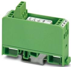
Módulo de relés, con mini-relé de conmutación soldado, contacto (AgNi): Potencias medianas hasta grandes, 2 contactos conmutados, tensión de entrada 230 V AC
