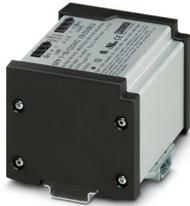
Protección de dispositivos, según el tipo 3/clase III, con filtro antiparasitario de red contra tensiones parásitas de alta frecuencia, para redes de alimentación de corriente monofásicas con N y PE separados (sistema de 3 conductores: L1, N, PE), con contacto de indicación remota.
