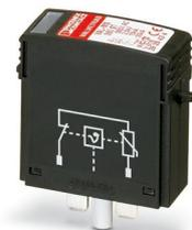
Protección enchufable contra sobretensiones tipo 2 con varistor de alta potencia para elemento de base VAL-MS, con control térmico, indicación óptica de defecto. Ejecución: 580 V AC
