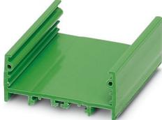
Cajas de perfil extruido, Perfil básico, anchura de perfil (interior): 41,85 mm, anchura de perfil (exterior): 44,8 mm, longitud: 1000 mm, altura: 44,8 mm, profundidad: 18,95 mm, Nota: longitud de perfil necesaria = longitud de la placa de circuito impreso - 3 mm
