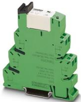
PLC-INTERFACE para corrientes constantes elevadas, compuesto de borne de base PLC-BSP. ..../21 HC con conexión por resorte y relé en miniatura enchufable, para montar sobre carril NS 35/7,5, corriente constante límite hasta 10 A, 1 contacto conmutado, tensión de entrada 60 V DC
