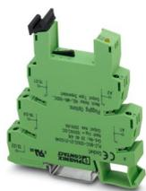
Borne de base PLC de 14 mm para corrientes constantes elevadas con conexión por resorte, sin equipamiento de relé o relé de estado sólido, para montar sobre carril NS 35/7,5, 1 contacto conmutado, tensión de entrada 60 V DC
