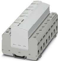
Descargador de corrientes de rayo enchufable y a prueba de corriente de fuga, para tensiones nominales elevadas, según el tipo 1/clase I, para redes de alimentación trifásicas con N y PE separados (L1, L2, L3, PE, N).
