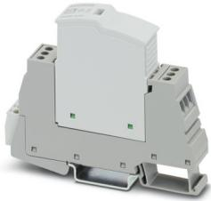
Protección contra sobretensiones de tipo 2/3, formada por protección enchufable y elemento de base, con indicador de estado e indicación remota integrados para redes de fuente de alimentación monofásicas. Tensión nominal: 120 V AC/DC
