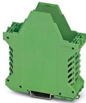
Caja para carril DIN, Parte inferior de la caja con pasador de metal, con contacto FE, diseño alto, con rendijas de ventilación, anchura: 35,2 mm, altura: 99 mm, profundidad: 107,3 mm, color: verde (similar RAL 6021), puentado transversal: sin conector de bus, número de polos conector transversal: no relevante
