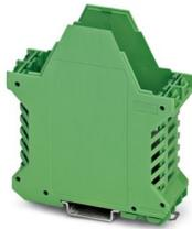
Caja para carril DIN, Parte inferior de la carcasa con pasador de metal, diseño alto, con rendijas de ventilación, anchura: 35,2 mm, altura: 99 mm, profundidad: 107,3 mm, color: verde (similar RAL 6021), puentado transversal: sin conector de bus, número de polos conector transversal: no relevante
