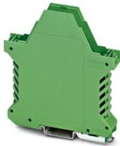
Caja para carril DIN, Parte inferior de la caja con pasador de metal, con contacto FE, diseño alto, con rendijas de ventilación, anchura: 17,6 mm, altura: 99 mm, profundidad: 107,3 mm, color: verde (similar RAL 6021), puentado transversal: sin conector de bus, número de polos conector transversal: no relevante
