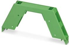
Caja para carril DIN, Parte superior de la carcasa para bornas para placa de circuito impreso con conexión por tornillo, anchura: 12,6 mm, altura: 99 mm, profundidad: 45,85 mm, color: verde (similar RAL 6021)
