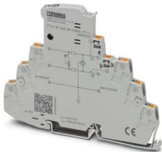
Protección contra sobretensiones con indicación de estado integrada e interrupción por cuchilla para un circuito de señales flotante de 2 hilos, p. ej. bucle de corriente de 0(4)...20 mA, homologación EX e para zona 2, apta para HART. Puede utilizarse en circuitos orientados a la seguridad hasta SIL 3.
