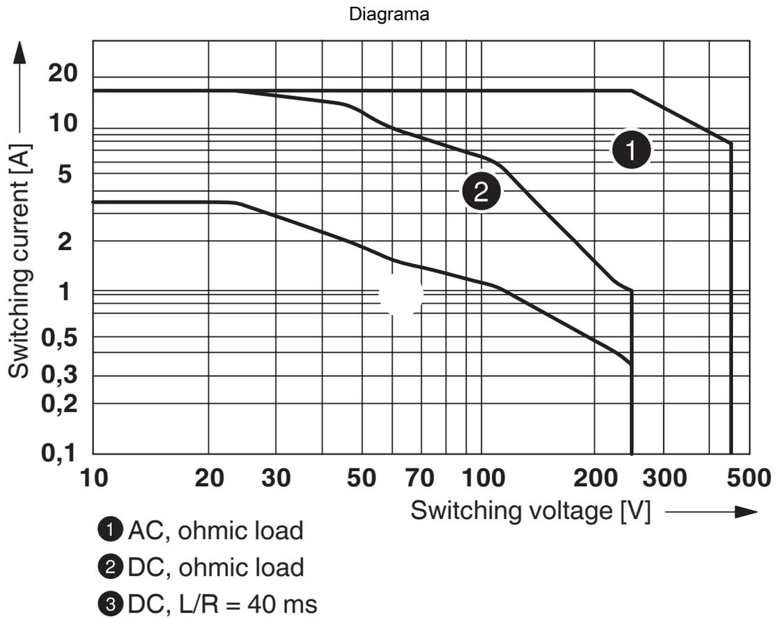
Potencia de ruptura
