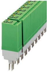
Relé enchufable de estado sólido de potencia, con indicador luminoso y circuito de protección en circuito de entrada y salida, entrada: 220 V DC, salida: 15-220 V DC/máx. 1 A, enchufable a bloques de bornes de base
