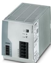
Fuente de alimentación TRIO conmutada en primario para el montaje sobre carril DIN, entrada: trifásica, salida: 24 V DC/40 A, boost dinámico, tecnología de conexión rápida sin herramientas para cables rígidos y flexibles con puntera
