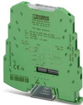
Convertidor de temperatura configurable para la conexión de termorresistencias y transmisores de resistencia de 2, 3, 4 conductores. Configurable mediante interruptores DIP o con la funcionalidad ampliada por software. Conexión por tornillo, configuración estándar.
