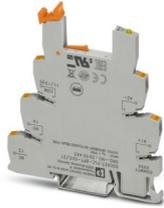
Borne de base PLC de 6,2 mm con conexión push-in, sin equipamiento de relé o relé de estado sólido, para montar sobre carril NS 35/7,5, 1 contacto conmutado, tensión de entrada 5 V DC
