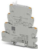
PLC-INTERFACE con contacto de retorno, compuesto de borne de base con conexión push-in y relé de estado sólido en miniatura integrado, para el montaje sobre carril NS 35/7,5, 1 contacto de cierre, entrada: 24 V DC, salida: 3-33 V DC/10 A
