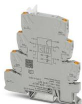
PLC-INTERFACE para aplicaciones NAMUR, compuesto de borna de base PLC-BPT.../21 con conexión push-in y circuito integrado, para el montaje sobre carril DIN NS 35/7,5, salida con conmutación positiva, tensión de alimentación 24 V DC
