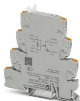
PLC-INTERFACE para aplicaciones ferroviarias, compuesto de borne de base con conexión push-in y relé de estado sólido en miniatura integrado, rango:  $0,7 \times U_N$  hasta  $1,25 \times U_N$ , rango de temperatura:  $-25 \text{ °C}$  hasta  $+70 \text{ °C}$ , 1 contacto de cierre, entrada: 72 V DC, salida: 12-140 V DC/3 A
