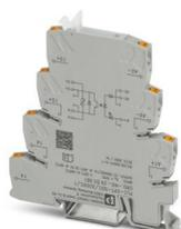
INTERFACE PLC, relé de estado sólido integrado, con conexión push-in, para montaje sobre carril simétrico NS 35/7,5, entrada: 5 V DC, salida: 12-300 V DC/1 A
