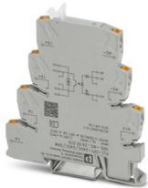
PLC-INTERFACE para aplicaciones ferroviarias, compuesto de borne de base con conexión push-in y relé de estado sólido en miniatura integrado, rango:  $0,7 \times U_N$  hasta  $1,25 \times U_N$ , rango de temperatura:  $-25 \text{ °C}$  hasta  $+70 \text{ °C}$ , 1 contacto de cierre, entrada: 24 V DC, salida: 3-33 V DC/3 A
