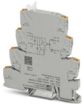
PLC-INTERFACE con contacto conmutado eléctrico, compuesto de borne de base PLC-BPT... /21 con conexión push-in y relé de estado sólido en miniatura integrado, para el montaje sobre carril NS 35/7,5, 1 contacto conmutado, entrada: 24 V DC, salida: 3-48 V DC/500 mA
