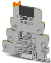
PLC-INTERFACE para funciones de salida, compuesto de borne de base PLC-BPT.../ACT con conexión push-in y relé de estado sólido en miniatura enchufable, para el montaje sobre carril NS 35/7,5, 1 contacto de cierre, entrada: 24 V DC, salida: 3-33 V DC/3 A
