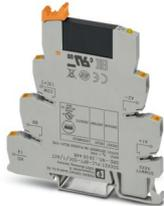
PLC-INTERFACE para funciones de salida, compuesto de borne de base PLC-BPT.../ACT con conexión push-in y relé de estado sólido en miniatura enchufable, para el montaje sobre carril NS 35/7,5, 1 contacto de cierre, entrada: 5 V DC, salida: 3-33 V DC/3 A
