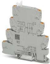
PLC-INTERFACE para señal TTL, compuesto de borne de base PLC-O.../TTL con conexión push-in y relé de estado sólido integrado, para el montaje sobre carril NS 35/7,5, 1 contacto de cierre, entrada: 24 V DC, salida: TTL (5 V DC)
