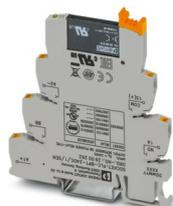
PLC-INTERFACE para funciones de entrada, compuesto de borne de base PLC-BPT.../SEN con conexión push-in y relé de estado sólido en miniatura enchufable, para el montaje sobre carril NS 35/7,5, 1 contacto de cierre, entrada: 24 V DC, salida: 3-48 V DC/100 mA
