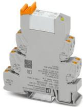
PLC-INTERFACE, compuesto de borne de base PLC-BPT.../21-21 con conexión push-in y relé en miniatura enchufable con contacto de oro multicapa, para montar sobre carril NS 35/7,5, 2 contactos conmutados, tensión de entrada 24 V DC
