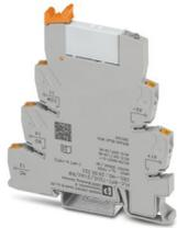
PLC-INTERFACE para aplicaciones ferroviarias, compuesto de borne de base con conexión push-in y relé en miniatura enchufable con contacto de oro multicapa, rango:  $0,7 \times U_N$  hasta  $1,25 \times U_N$ , clase de temperatura TX:  $-40\text{ °C}$  hasta  $+70\text{ °C}$ , 1 contacto conmutado, tensión de entrada 72 V DC
