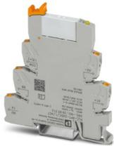
PLC-INTERFACE para funciones de salida, compuesto de borne de base PLC-BPT.../ACT con conexión push-in y relé en miniatura enchufable con contacto de potencia, para montar sobre carril NS 35/7,5, 1 contacto de cierre, tensión de entrada 24 V DC
