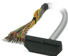
Cable redondo confeccionado; conexión 1: Conductores individuales (50-polos) (Los conductores están rotulados y equipados con punteras); conexión 2: Hembra de conexión IDC/FLK (1x 50-polos, 90 °-salida); longitud de cable: 4 m
