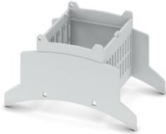
Caja para carril para el empleo en distribuidores de instalación según DIN 43880, Parte superior de la carcasa (U22) con rendijas de ventilación, Profundidad de montaje de tecnología de conexión: 22,35 mm, anchura: 53,6 mm, altura: 89,7 mm, profundidad: 49,78 mm, color: gris claro (similar RAL 7035)
