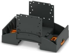
Caja para carril para el empleo en distribuidores de instalación según DIN 43880, Parte inferior de la carcasa con anclaje de base, anchura: 53,6 mm, altura: 89,7 mm, profundidad: 48,9 mm, color: negro (similar RAL 9005), puenteado transversal: Conector de bus para carril DIN (opcional), número de polos conector transversal: 16
