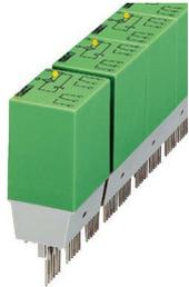
Soporte enchufable de relé, equipado con mini-relé de conmutación, contactos (AgNi): Potencias medianas hasta grandes, 2 contacto conmutado, tensión de entrada 48 V AC/DC, con indicación luminosa, enchufable en bloques de bornes de base
