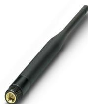
Antena omnidireccional, 2,4 GHz, ganancia: 5 dBi, polarización: lineal, ángulo de apertura: h/v 360°/45°, índice de protección: IP55, conexión: SMA (macho)
