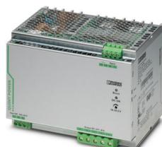
Fuentes de alimentación conmutadas de primario QUINT POWER, Conexión por tornillo, Montaje sobre carril DIN, SFB Technology (Selective Fuse Breaking), entrada: 1 fásico, salida: 24 V DC / 40 A
