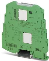
Amplificador de conexión NAMUR configurable para detectores de proximidad, contactos de conmutación sin potencial y con resistencia. 2 contactos abiertos en el lado de salida, con conexión por tornillo
